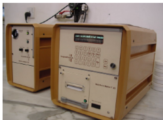
写真 18 ユニオン煙草会社の測定器 水分計: この他にもいくつかの測定機器があるがどれも煙草の物理的性状を測定するもので、成分等の分析器は備えていない。
