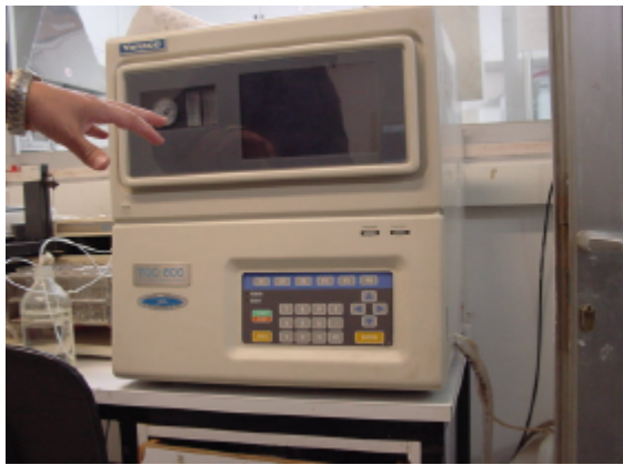
写真 13 CCクマトグラフの装置 日本製品。1998年導入されたが機能の一部がうまく動作していないと言う。
