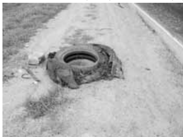
写真6 5 バースト（破裂）タイヤの残骸（1） 写真6 6 バースト（破裂）タイヤの残骸（2）
