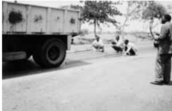
写真 2 23 ベンケルマン・ビームたわみ測定
