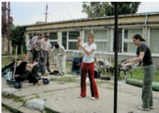
地下の地震波速度を測定実験中の専門家とカウンターパート* (ルーマニア地震災害軽減計画)
