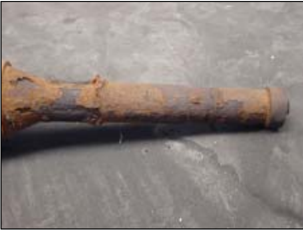
写真 21 ラダーストックの発錆
