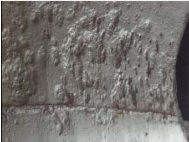
写真 15 シャフトトンネル外板部プロペラによる点腐
