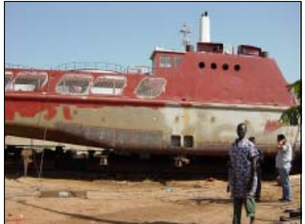
写真 14 左舷外板損傷部の取替え
