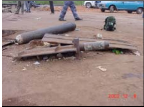
写真 8 舵及び舵軸損傷
