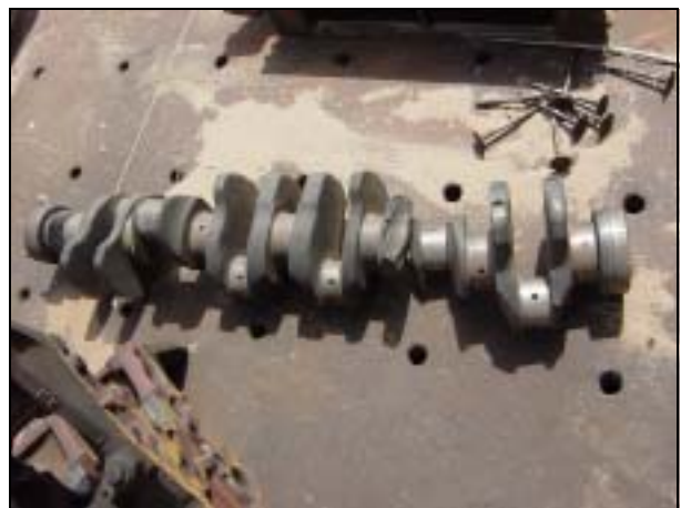
写真 24 左舷（操舵室側）の破損した主機関クランクシャフト
