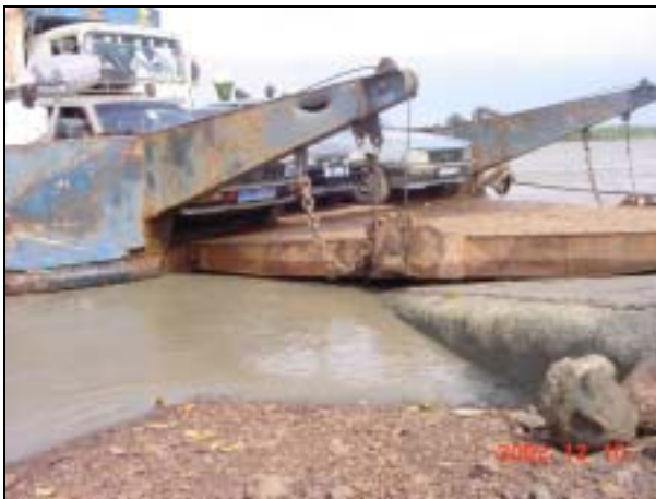
写真 39 着岸したジェームスアイランド号は係留設備がない
