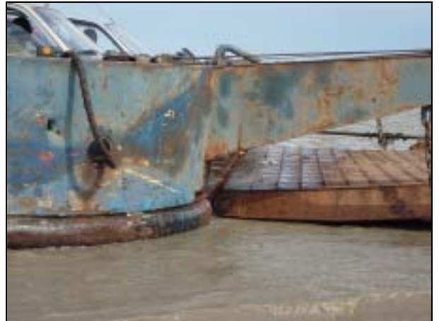
写真 4 ヒンジ、ヒンジピンは磨耗が著しい
