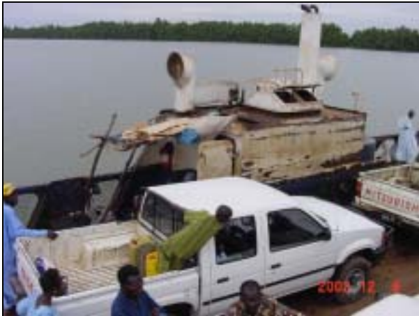
写真 3 エンジンケーシング外面は大型トラックの接触により損傷
