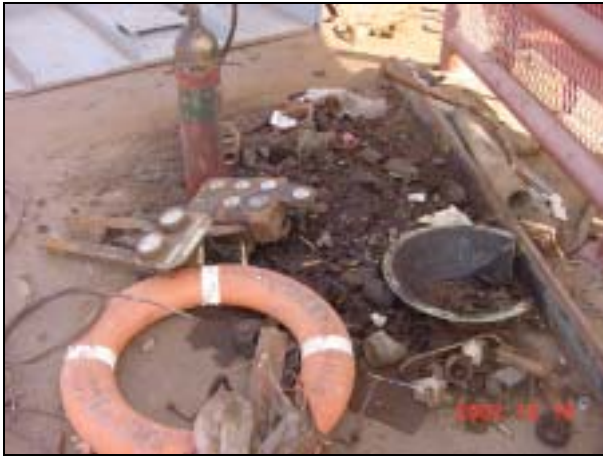
写真 27 主機関用、GS ポンプ用ゲージパネルは使用不可能
