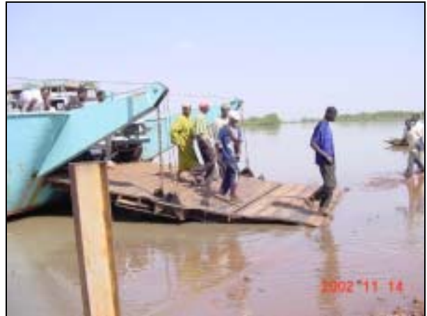
写真 34 バディブ号が着岸の際、満潮時のためスリップウエーに川水が流入している
