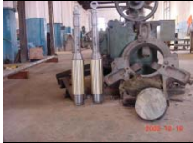
写真 22 の機械加工及びブッシュ圧入を完了した新規ラダーストック
