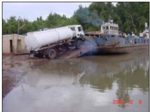
写真 36 ジェームスアイランド号の大型トラックの乗船の様子であり、船首底部が完全に川床に接触し、内底部に損傷が発生
