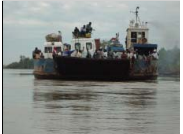
写真 2 過重量によりヒンジ部が変形し、ランプドアが右側に曲がっている
