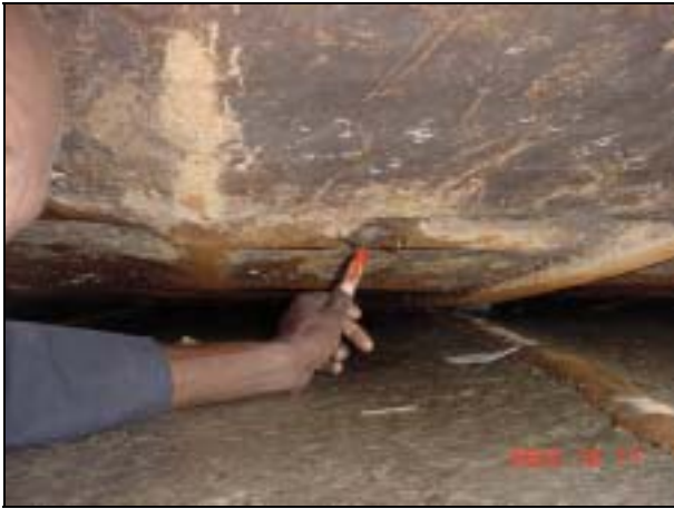
写真 7 船首外板部のクラック
