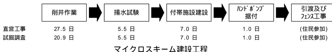
「ス」国側直営工事による井戸の付帯施設建設とハンドポンプ据付は RWSB の責任で実施する。日本側削井業者が実施する工事では削井、揚水試験、付帯施設建設及びハンドポンプ据付を実施する。引渡後のフェンス建設等は住民参加で実施される。基本設計調査時に実施した試掘調査による成功井 8 井は、機材到着後に「ス」国側の責任で付帯施設等の建設を行う。
