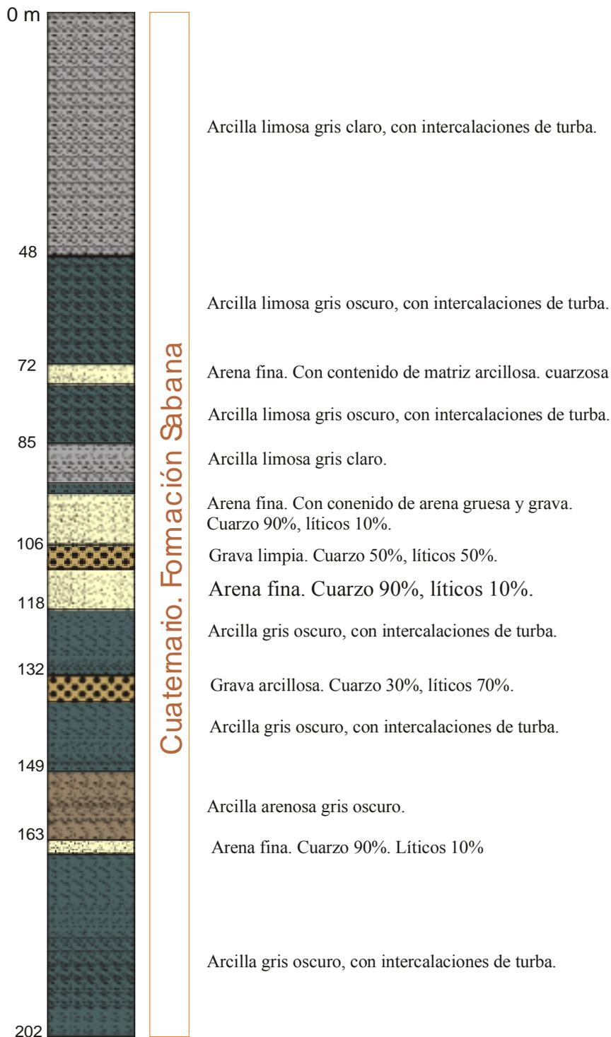
**Figura-1.2** Columna geológica de la perforación en Cuaternario (No 1 Gibraltar)
