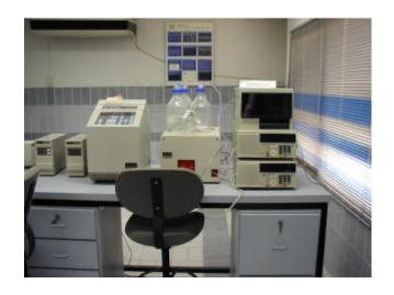
写真 22:SEPA が保有する分析機材 (高性能液体クロマトグラフ)
