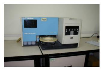
写真 23:SEPA が保有する分析機材 (イオン分析器)
