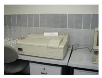
写真 21: SEPA が保有する分析機材 (紫外/可視分光光度計)
