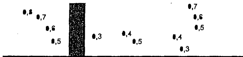
Рис. Значения коэффициентов трансформации при фронтальном обтекании здания.
