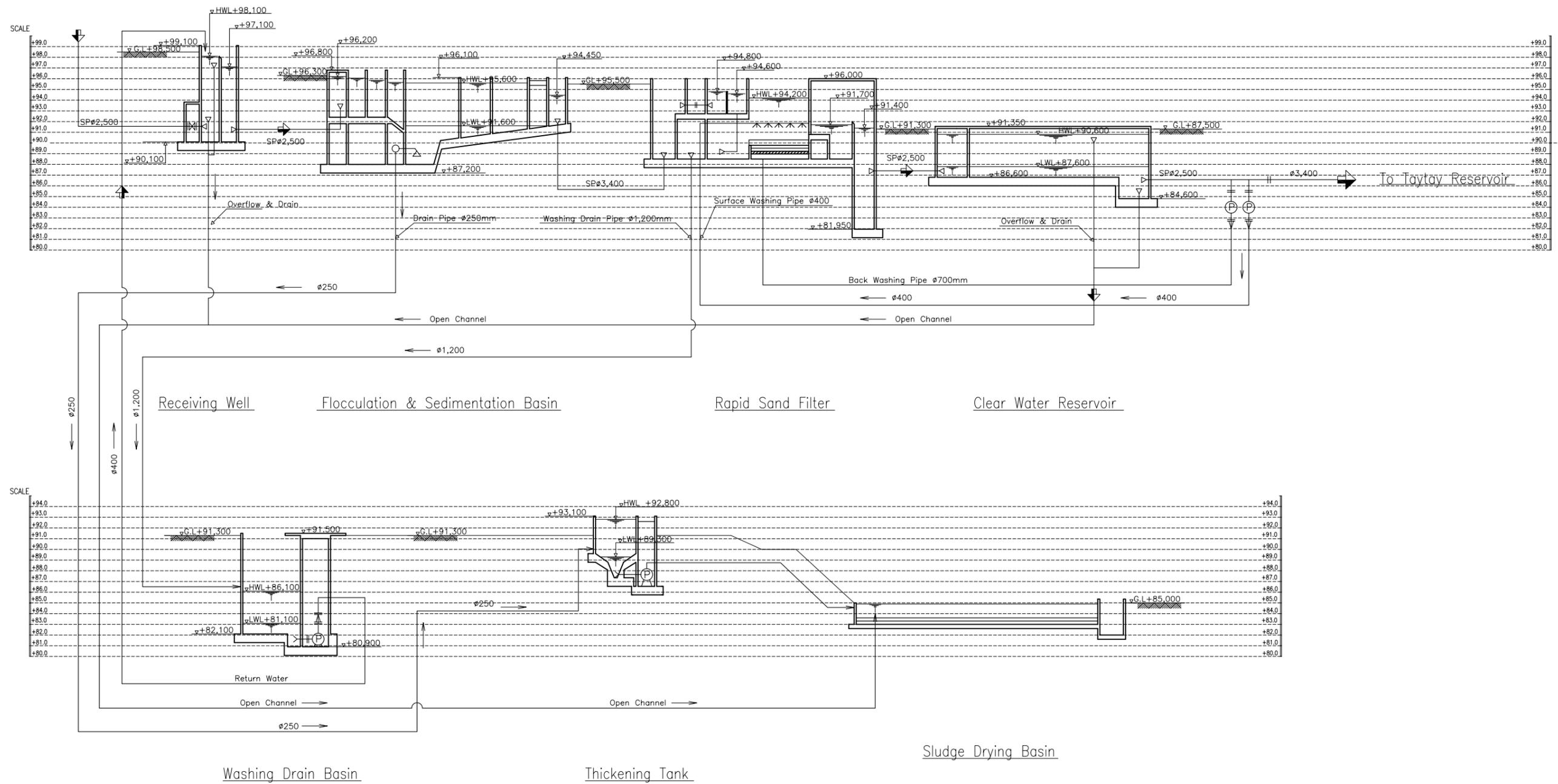
図 F4.7 モロン浄水場処理プロセス縦断面図
