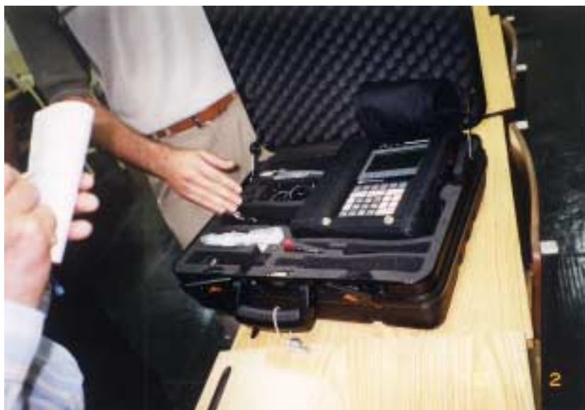
設備診断用器具(振動分析器) (SENAI フレデリコ・ジャコブ校)
