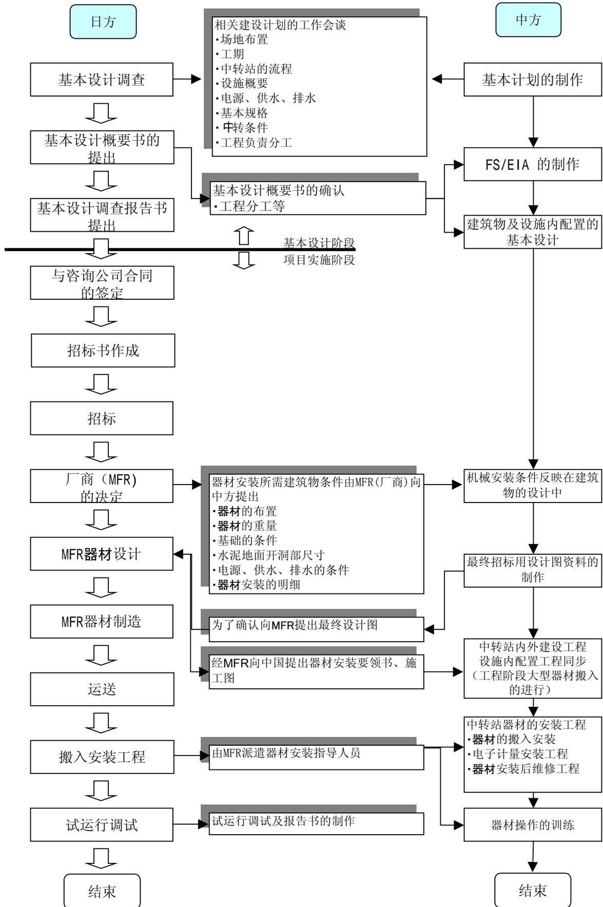
图 2.4-1 中转搬运站的建设作业流程
