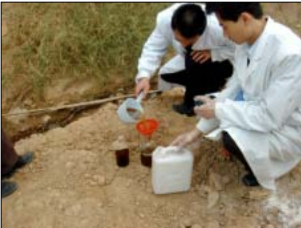
浸出水採取状況
