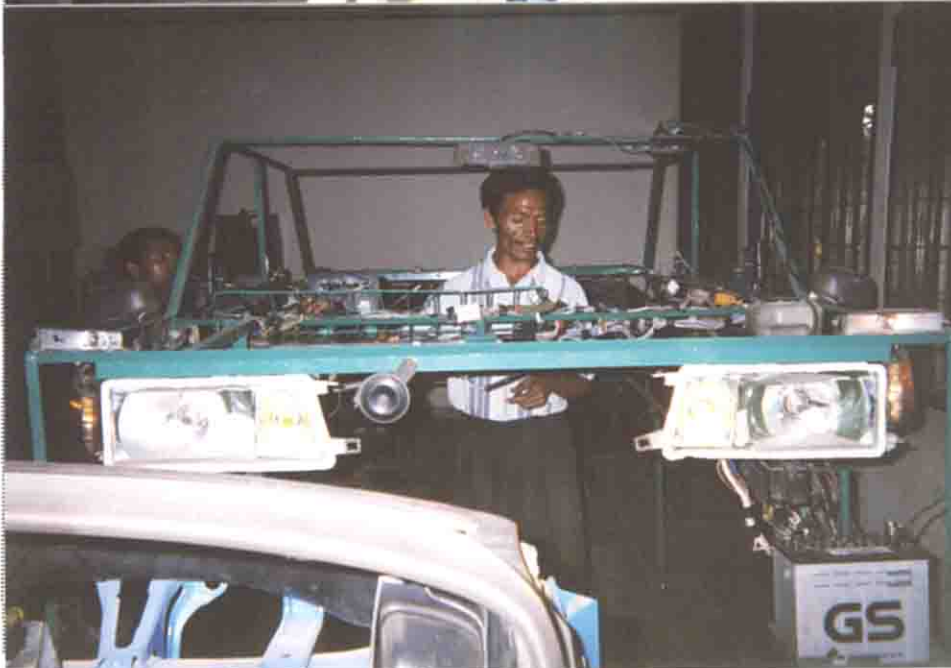
写真(30) BECORA 職業訓練学校 JICA専門家が製作した 自動車モデル。実際の 自動車を操作して内部 の仕組みが分かるモデル。
