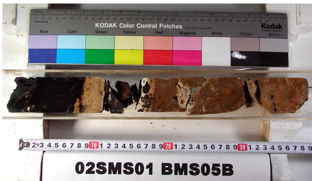
Drill. Len. 40cm, Thick. Sedim. 1cm, Core Len. 39cm, Crust 9cm
