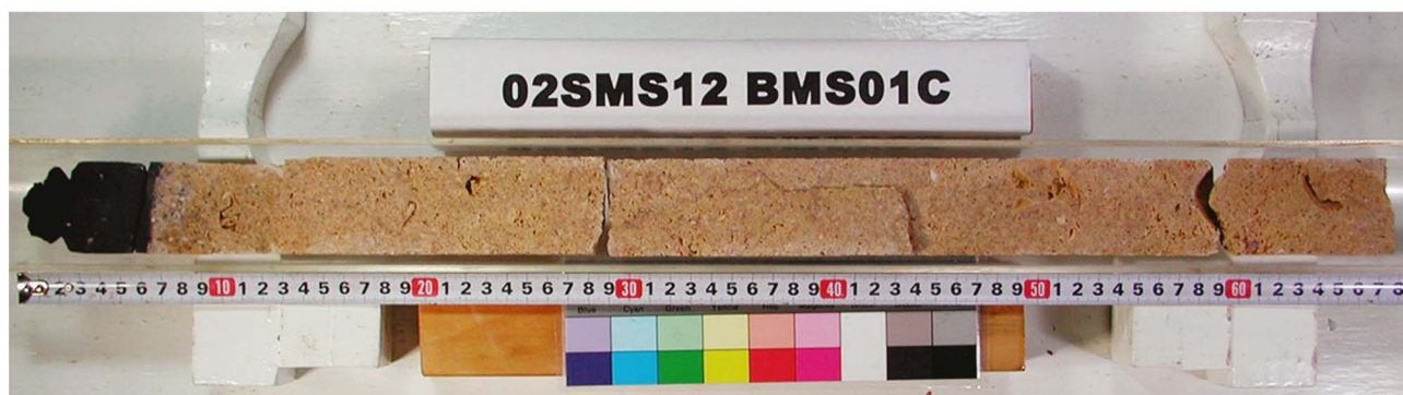
Drill. Len. 71cm, Thick. Sedim. 1cm, Core Len. 67cm, Crust 5cm
