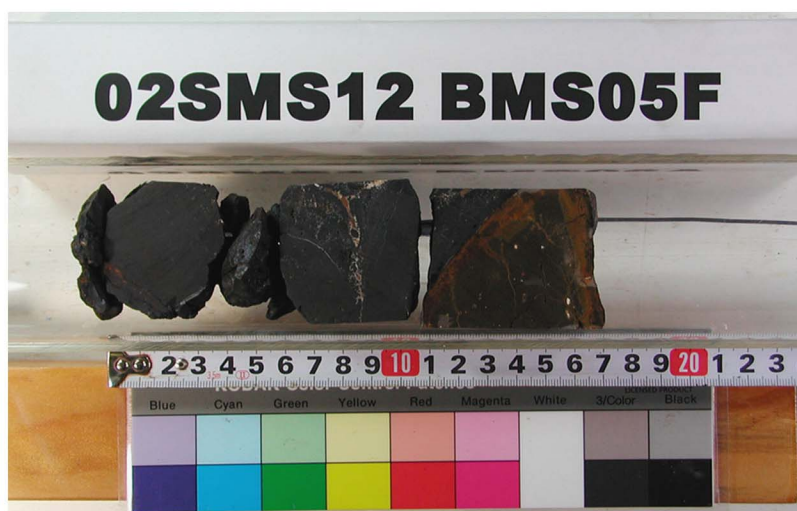
Drill. Len. 22cm, Thick. Sedim. 0cm, Core Len. 18cm, Crust 11cm
