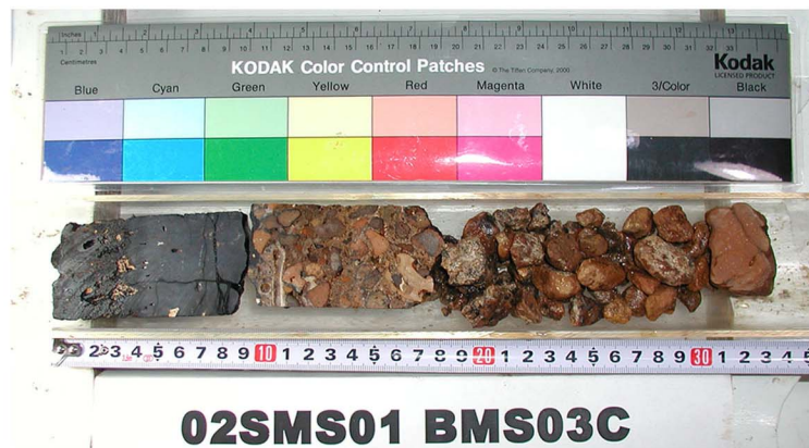
Drill. Len. 40cm, Thick. Sedim. 1cm, Core Len. 34cm, Crust 10cm
