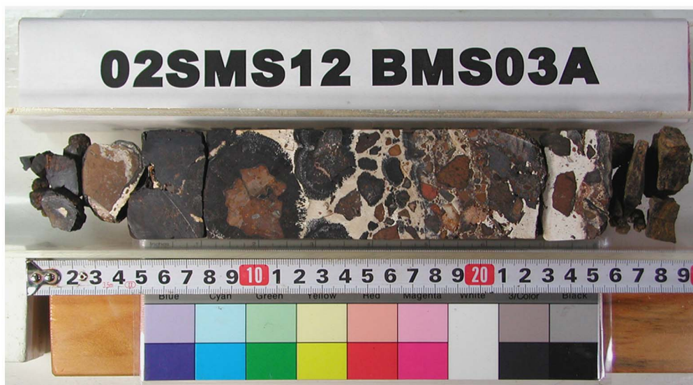
Drill. Len. 37cm, Thick. Sedim. 7cm, Core Len. 29cm, Crust 4.5cm
