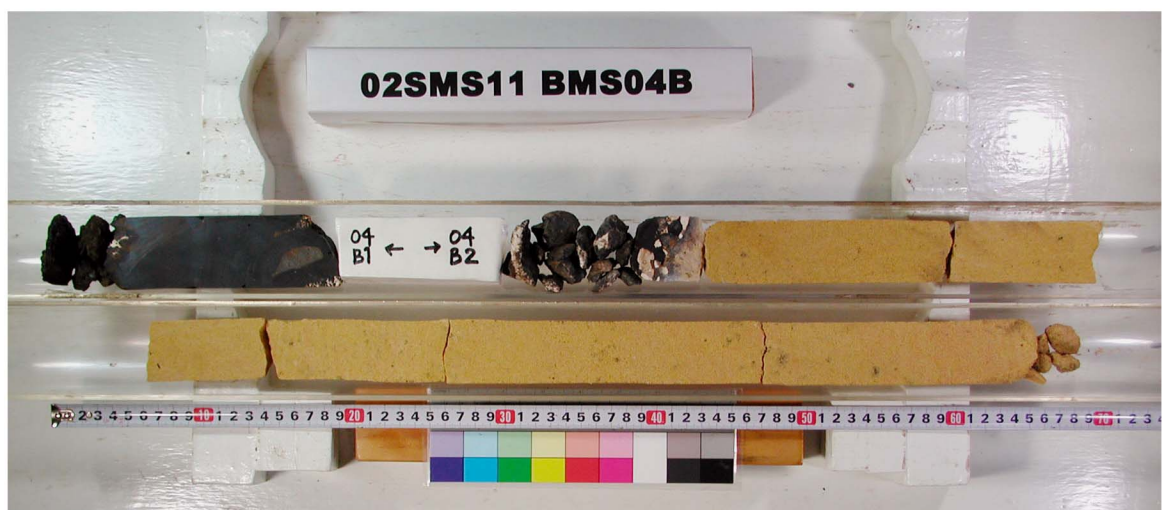
Drill. Len. 178cm、Thick. Sedim. 0cm、Core Len. 123cm、Crust 16cm、Nodule 2cm
