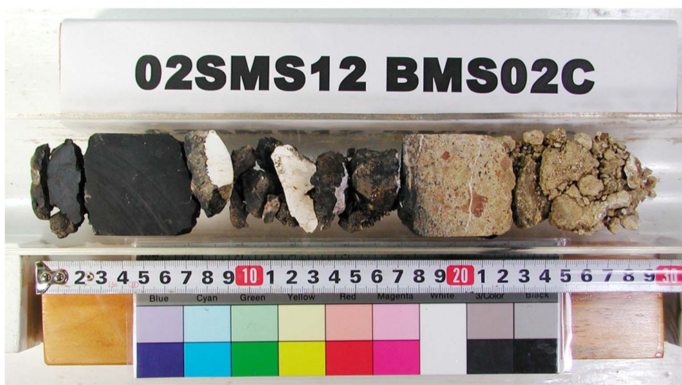
Drill. Len. 28cm, Thick. Sedim. 0cm, Core Len. 28cm, Crust 7cm
