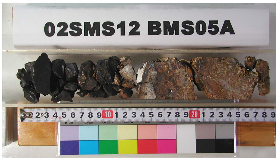
Drill. Len. 31cm, Thick. Sedim. 2cm, Core Len. 28cm, Crust 10cm
