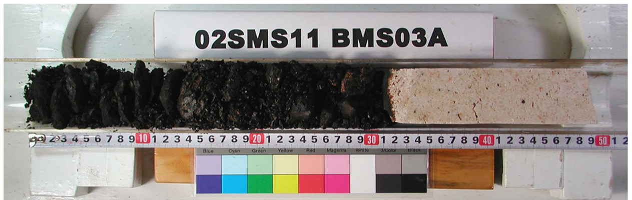
Drilli. Len. 49cm, Thick. Sedim. 0cm, Core Len. 47cm, Crust 32cm
