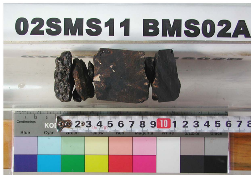
Drill. Len. 20cm, Thick. Sedim. 1cm, Core Len. 11cm, Crust 11cm
