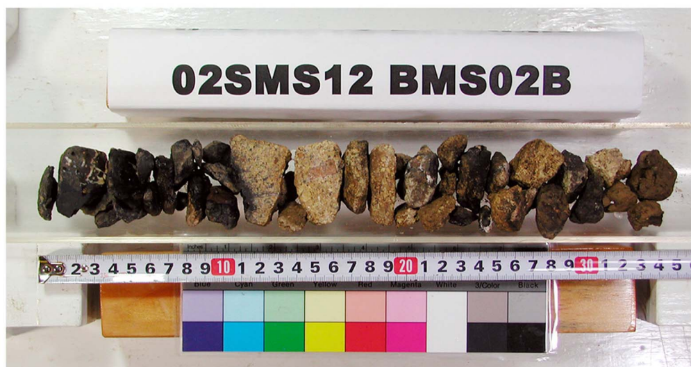
Drill. Len. 41cm, Thick. Sedim. 0cm, Core Len. 35cm, Crust 1.5cm
