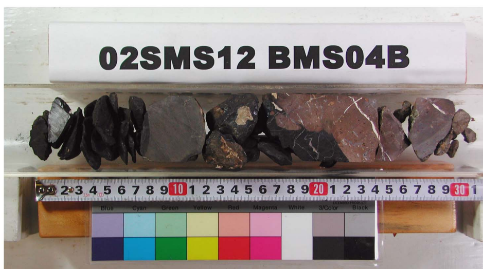
Drill. Len. 33cm, Thick. Sedim. 1cm, Core Len. 30cm, Crust 8cm
