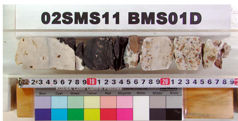
Drill. Len.176cm, Thick.Sedim.130cm, Core Len.28cm, Crust 7cm
