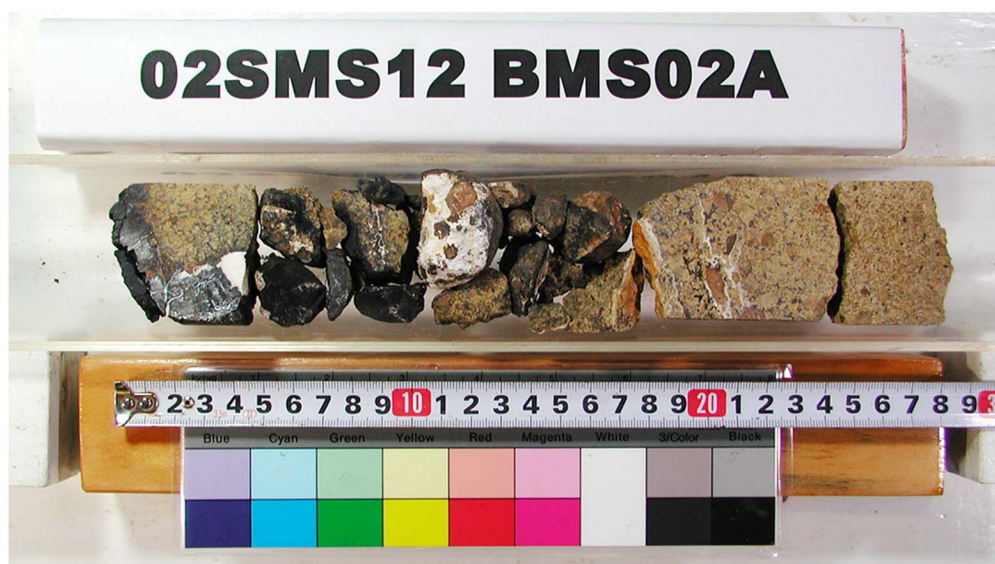
Drill. Len. 31cm, Thick. Sedim. 0cm, Core Len. 28cm, Crust 1.5cm
