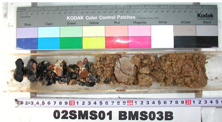
Drill. Len. 36cm, Thick. Sedim. 0cm, Core Len. 33cm, Crust 2cm
