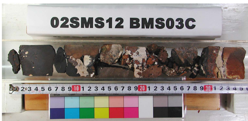
Drill. Len. 40cm, Thick. Sedim. 0cm, Core Len. 33cm, Crust 9cm
