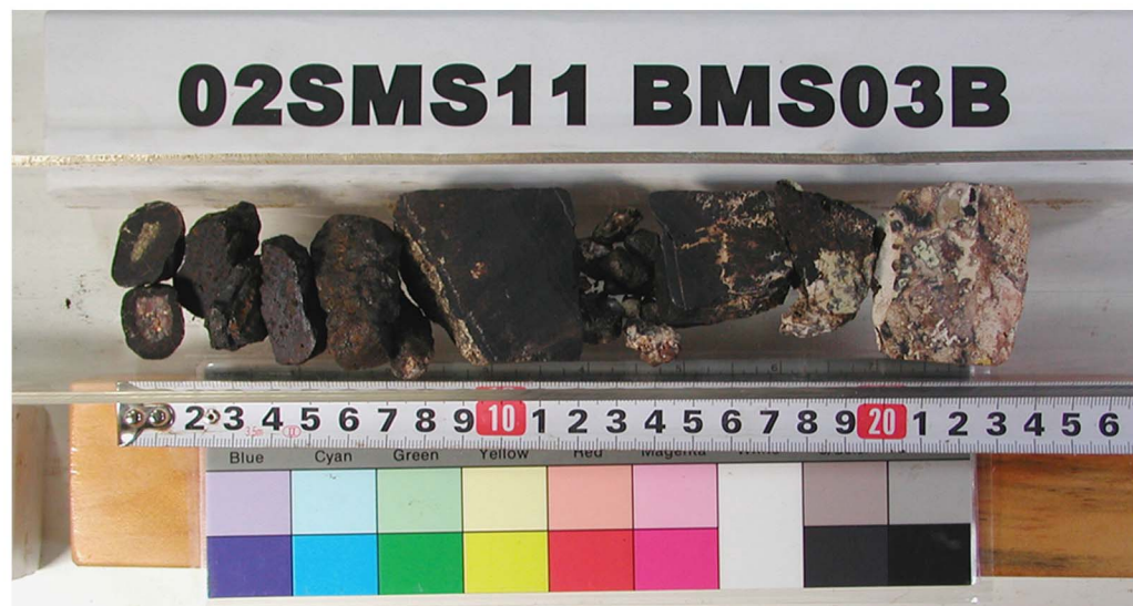
Drilli. Len. 43m, Thick. Sedim. 5cm, Core Len. 23cm, Crust 16cm
