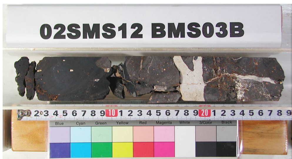
Drill. Len. 30cm, Thick. Sedim. 0cm, Core Len. 28cm, Crust 11cm
