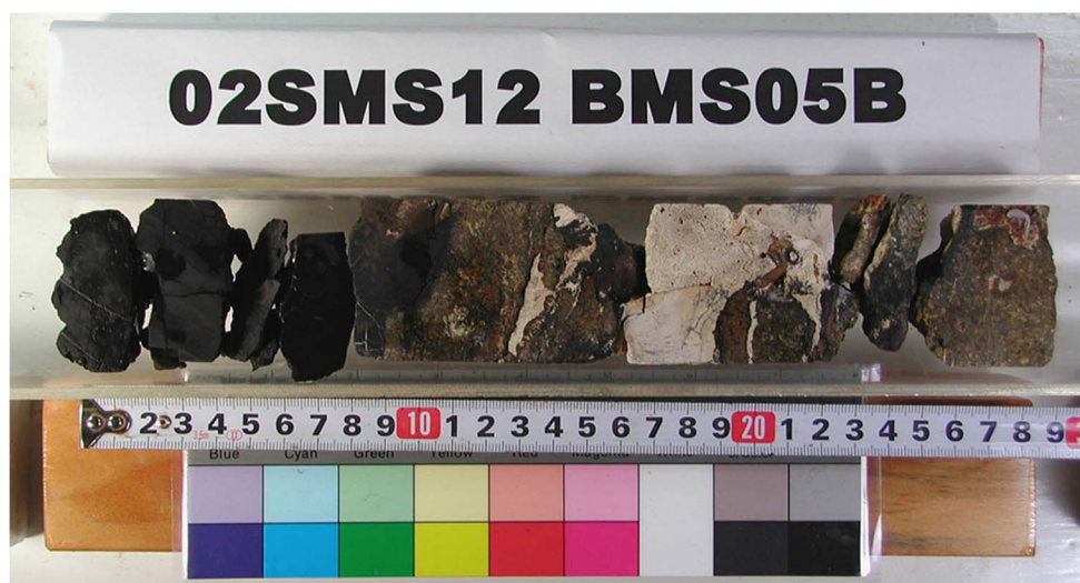
Drill. Len. 30cm, Thick. Sedim. 2cm, Core Len. 28cm, Crust 8cm
