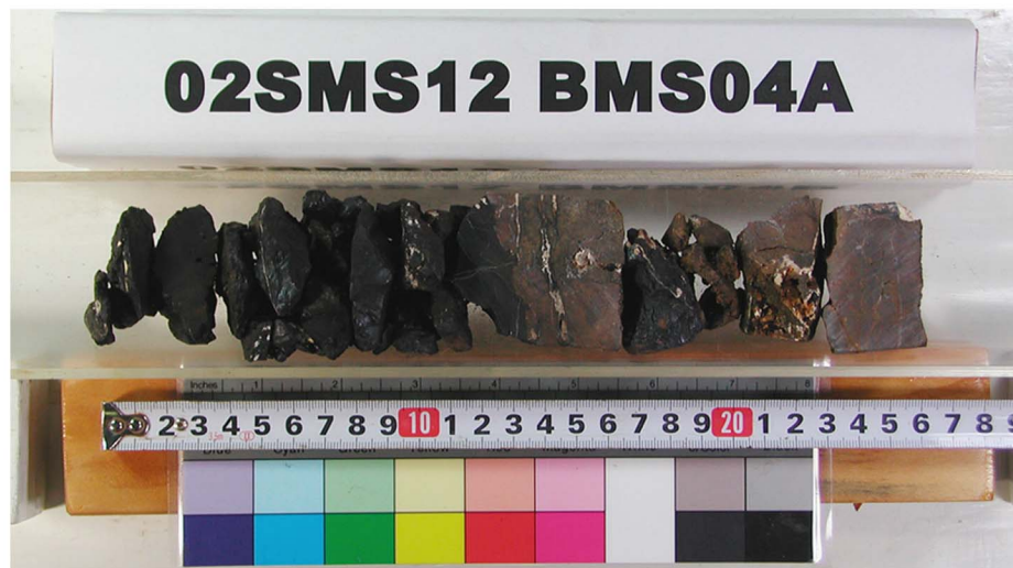
Drill. Len. 31cm, Thick. Sedim. 0cm, Core Len. 26cm, Crust 13cm
