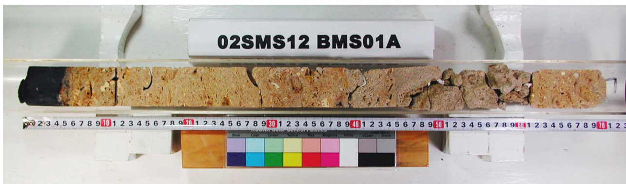
Drill. Len. 71cm, Thick. Sedim. 1cm, Core Len. 70cm, Crust 5cm
