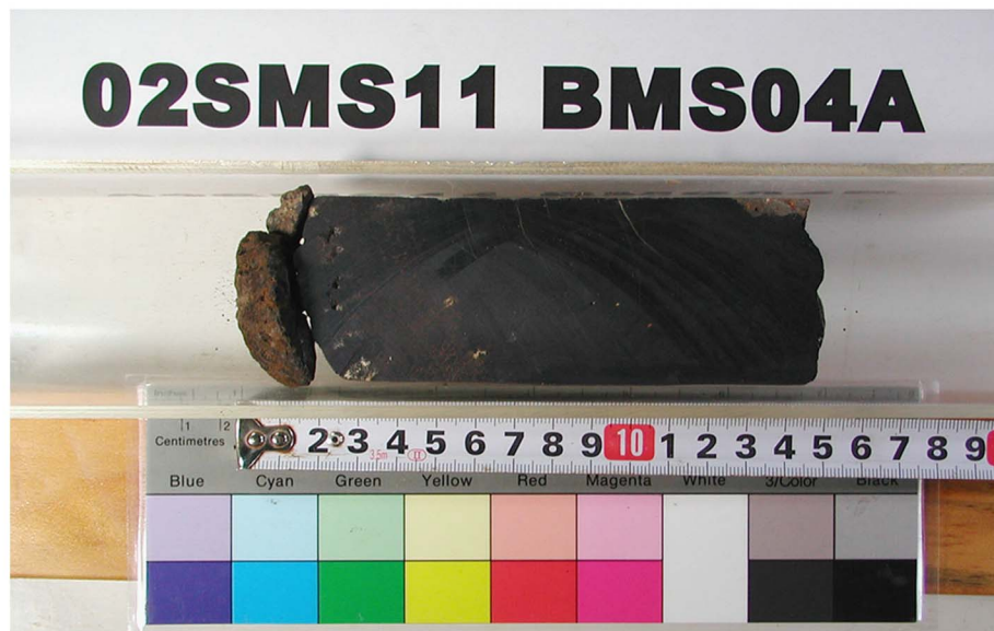
Drill. Len. 32cm、Thick. Sedim. 0cm、Core Len. 15cm、Crust 13cm、Nodule 2cm
