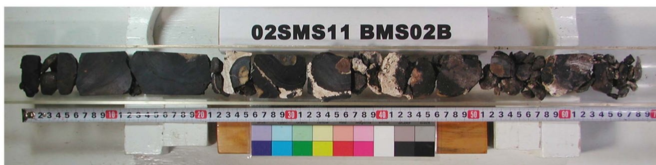
Drill. Len. 71cm, Thick. Sedim. 0cm, Core Len. 69cm, Crust 20cm
