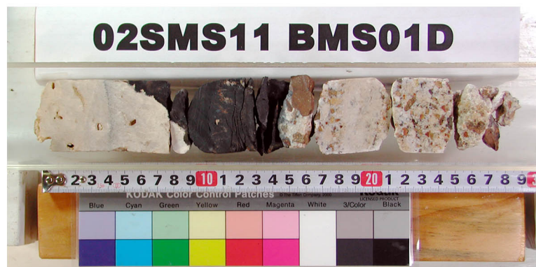
掘進長 176cm、被覆厚 130cm、コア長 28cm、クラスト厚 (3層構造) 7cm
