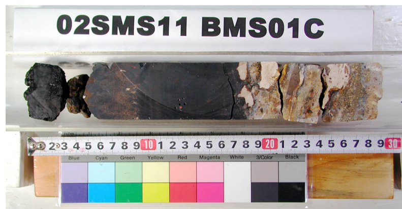
掘進長 33cm、被覆厚 0cm、コア長 28cm、クラスト厚 (3層構造) 16cm
