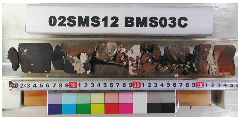
掘進長 40cm、被覆厚 0cm、コア長 33cm、クラスト厚 (2層構造) 9cm
