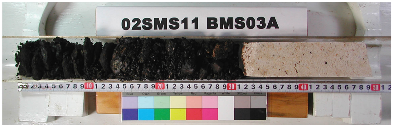
掘進長 49cm、被覆厚 0cm、コア長 47cm、クラスト厚 32cm (クラストは礫状に破碎され詳細不明)
