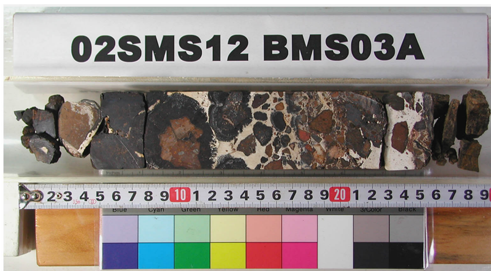
掘進 37cm、被覆厚 7cm、コア長 29cm、クラスト厚 4.5cm(ノジュール含む)
