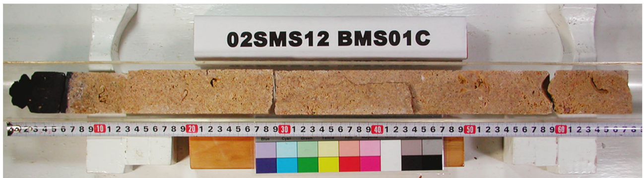
掘進長 71cm、被覆厚 1cm、コア長 67cm、クラスト厚 (3層構造) 5cm
