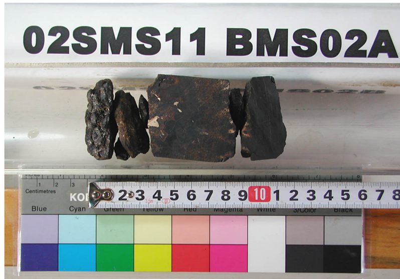
掘進長 20cm、被覆厚 1cm、コア長 11cm、クラスト厚 (2層構造) 11cm 以上
