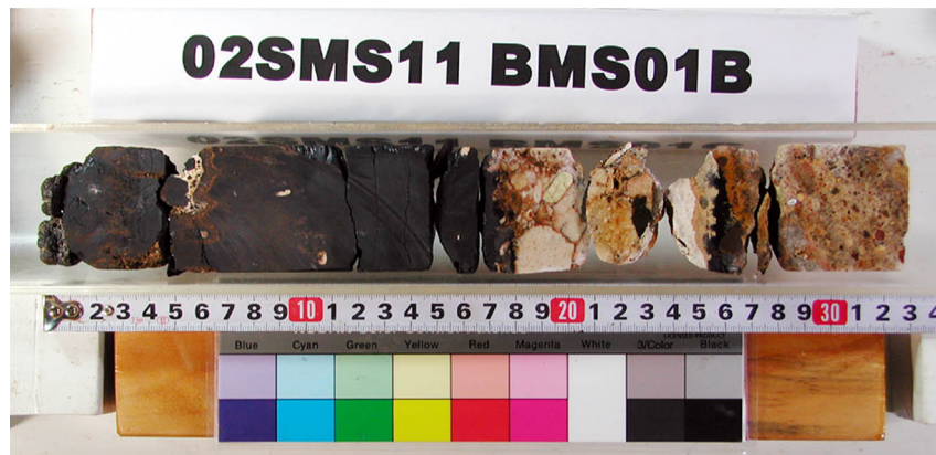
掘進長 34cm、被覆厚 0cm、コア長 32cm、クラスト厚 (2層構造) 16cm
