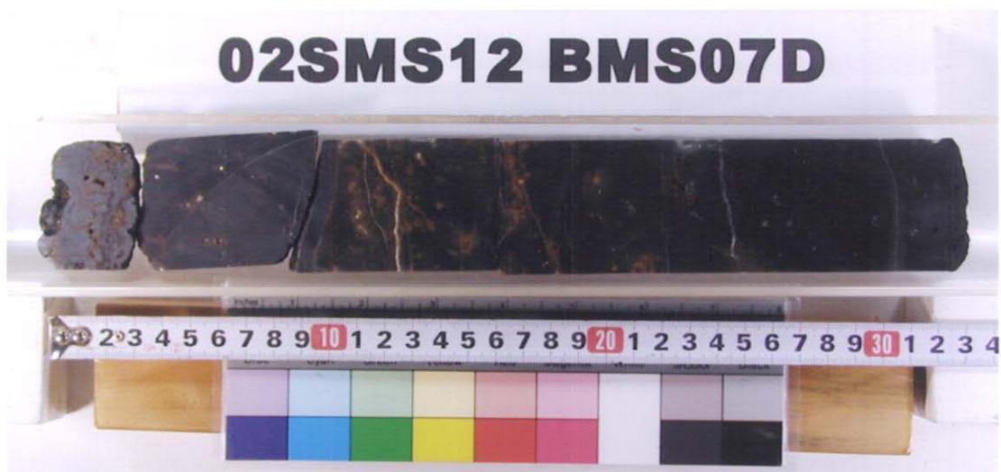
掘進長 34cm、被覆厚 0cm、コア長 32cm、クラスト厚 (2層構造) 10cm
