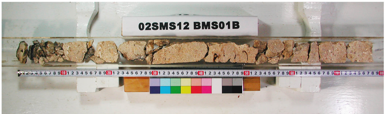
掘進長 82cm、被覆厚 5cm、コア長 77cm、クラスト厚 0cm(コーティングのみ)
