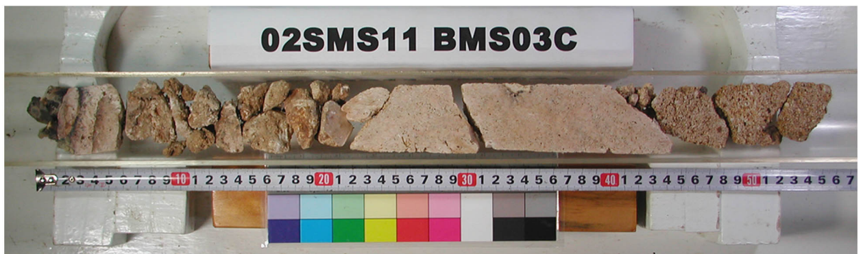
掘進長 107cm、被覆厚 15cm、コア長 55cm、クラスト厚 0cm(コーティングのみ)
