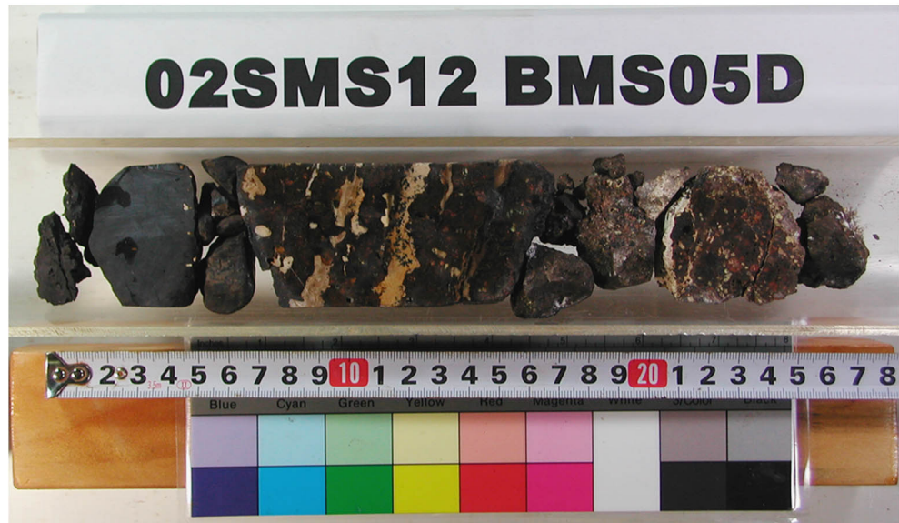
掘進長 32cm、被覆厚 0cm、コア長 25cm、クラスト厚 (2層構造) 5cm
