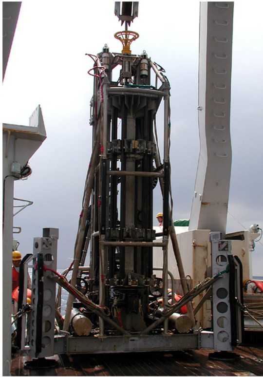
ボーリング・マシン・システム (BMS)
