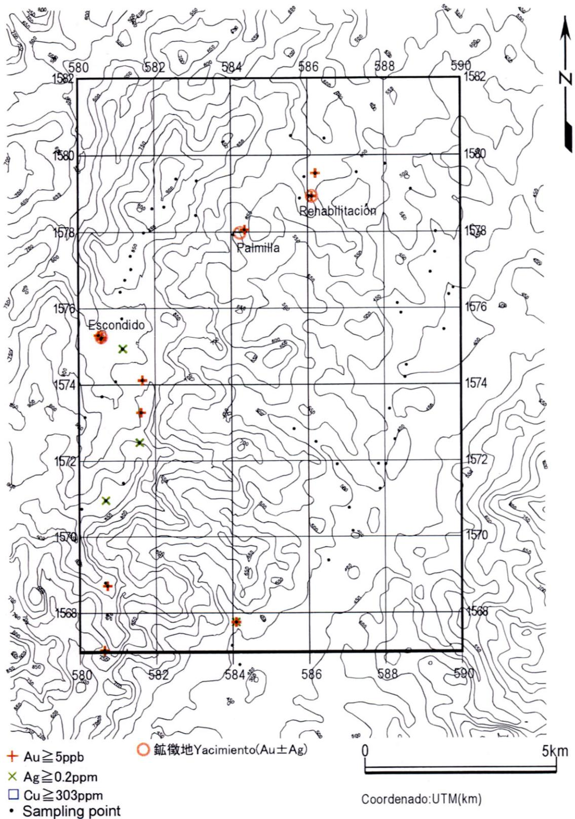
A-21 Palmillas地区岩石地化学探査異常値分布図 (Au, Ag, Cu)
