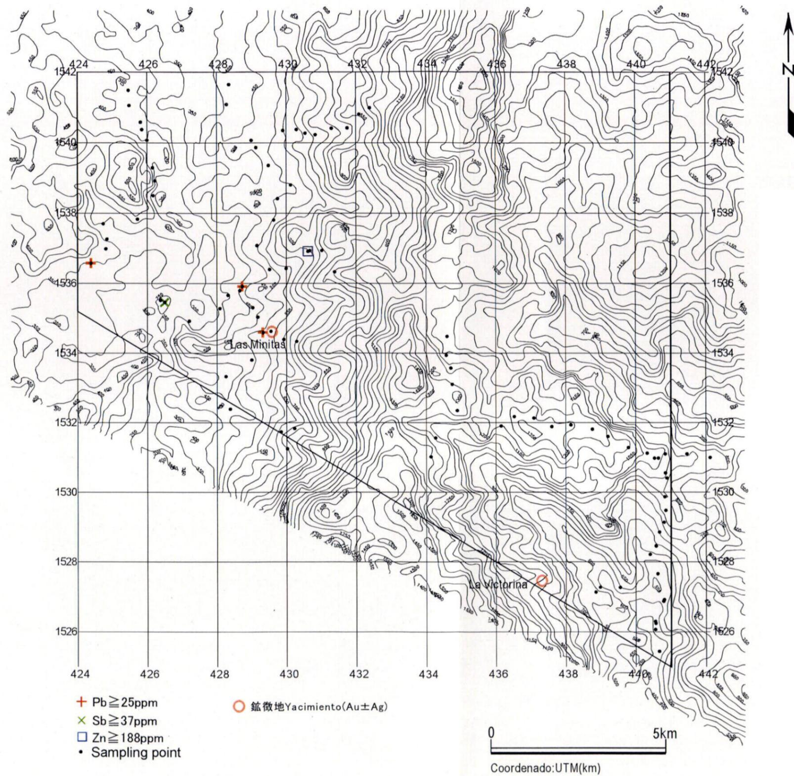
A-8 Aguanqueterique地区岩石地化学探査異常値分布図 (Pb, Sb, Zn)
