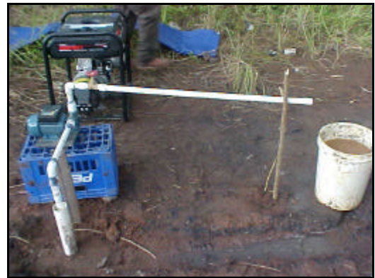
Fotografía 10. Para el pozo #2 se pudo notar que el agua tenía un color chocolate rojizo
