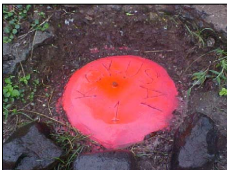
Fotografías 16 y 17. Vista de planta de monumentos de control “Kokusai 1” y “Kokusai 2”
