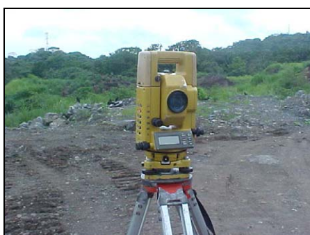
Fotografías 11 y 12. Estación Total marca TOPCON GTS-300
