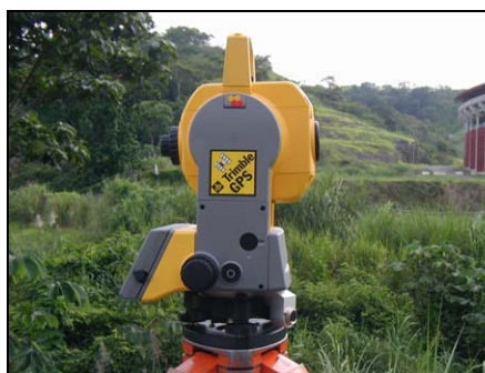
Fotografías 9 y 10. Estación Total marca TRIMBLE 3605 CE
