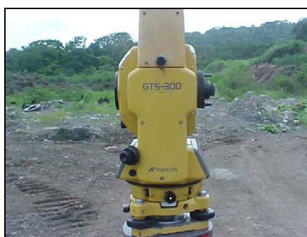
Fotografías 11 y 12. Estación Total marca TOPCON GTS-300
