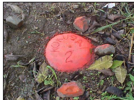
Fotografías 16 y 17. Vista de planta de monumentos de control “Kokusai 1” y “Kokusai 2”
