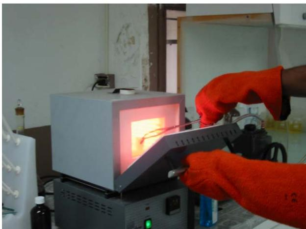
El contenido de cenizas y sólidos volátiles fue analizado por medio de la incineración de las muestras
