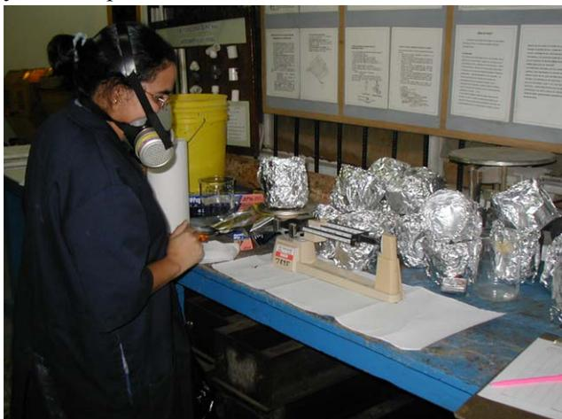
Medición de peso antes y después de secado, para obtener el contenido de humedad
