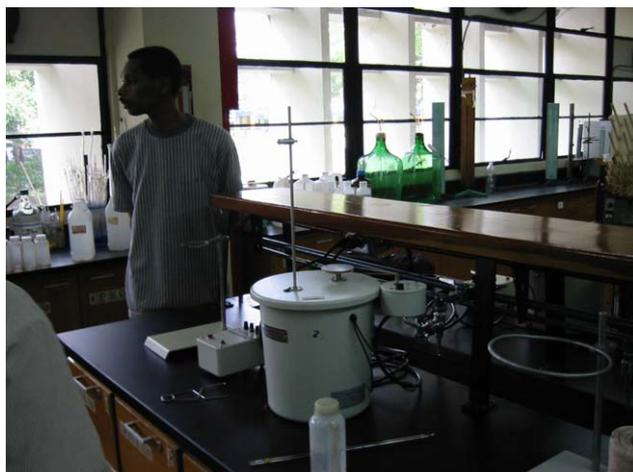
El poder calorífico inferior de los desechos fue analizado por medio del uso de una bomba calorímetra
