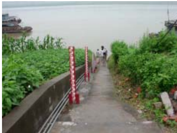
No.54 沙洋 バブル式水位計を採用。データの送信は、700m離れた観測所までVHFを採用し、観測所からはインマルサットCを採用する
