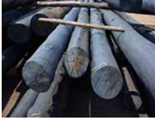
クレオソート処理後の木柱
