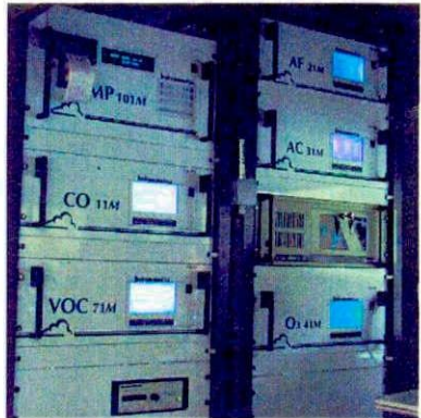
移動観測車の内部 (SO 2 、NO x 、CO、O 3 、VOC の観測が可能)
