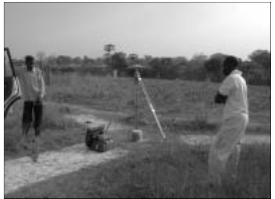
標定点GPS測量
