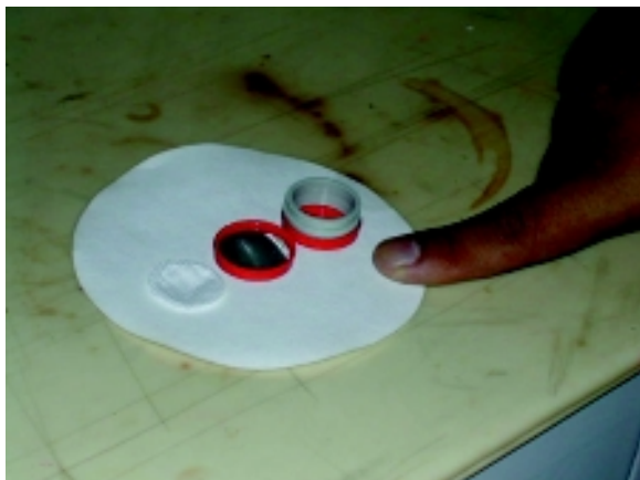
省環科設計院開発の簡易SO 2 測定器 横浜市公害研究所のタイプと類似
