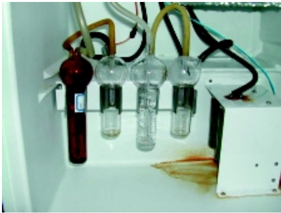
自動サンプラーのインピンジャー 左からNO 2 用、トラップ、SO 2 用、トラップ
