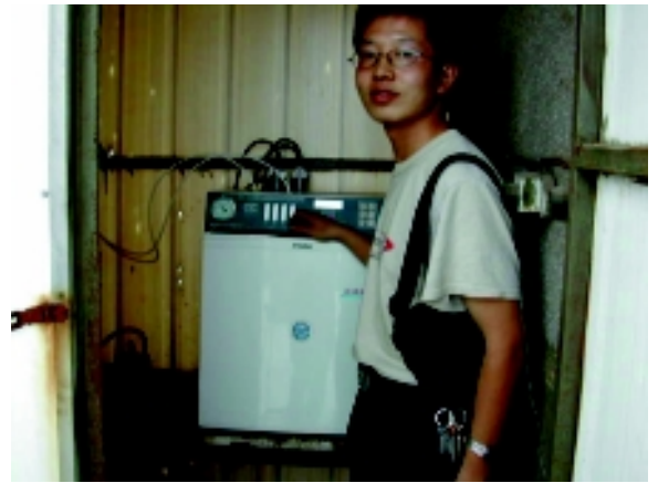
SO 2 、NO 2 用自動サンプラー小型冷蔵庫で温度調整をしている上はコントローラー
