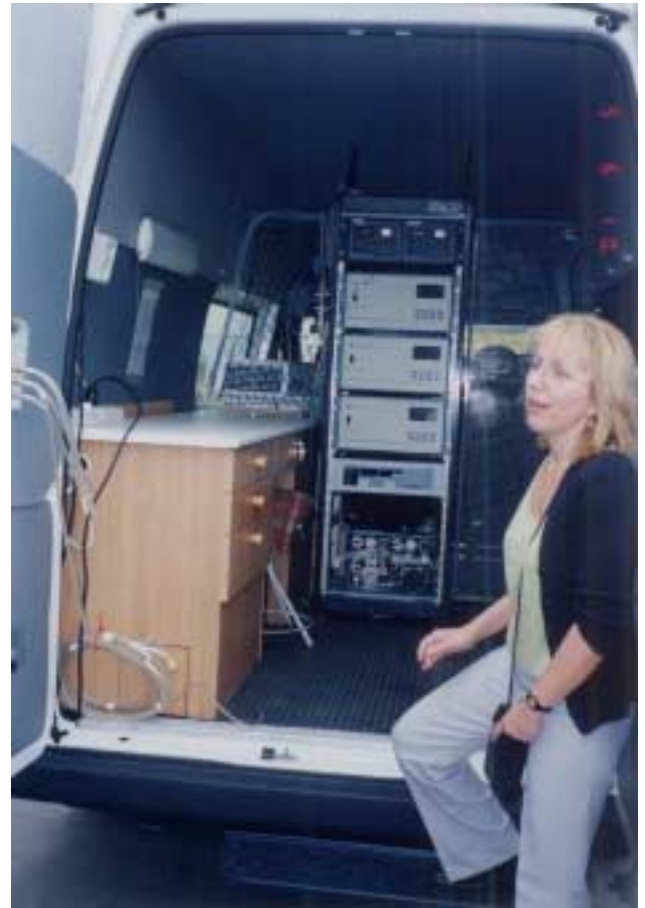
37 .同監督署の移動式測定車。大 気モニタリングを実施中
