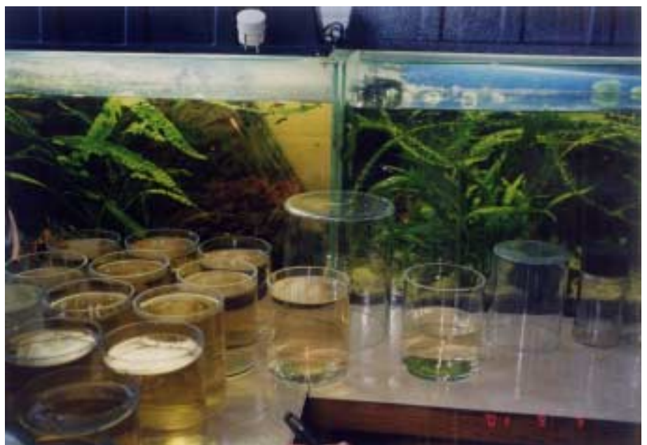
33. 同監督署内ラボラトリ。 ミジンコを用いた生物 モニタリングを実施中
