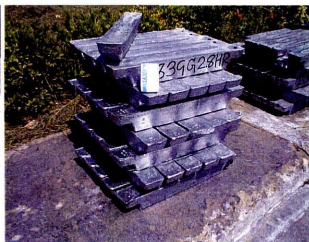
廃バッテリーリサイクル(3:回収鉛)
