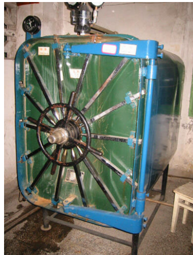
中央材料室：高压滅菌器
