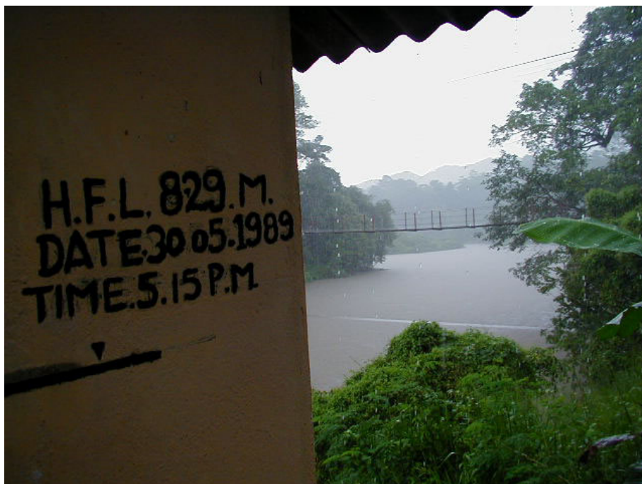
水位観測小屋 1989年5月30日の洪水の水位
