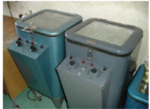
細菌検査室 培養管のシェーカー (恒温装置付)
