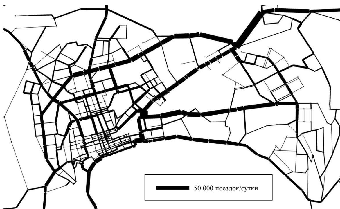
Рисунок 10.8.2 Распределение потока легковых автомобилей в 2010 году (случай "ничего не делать")
