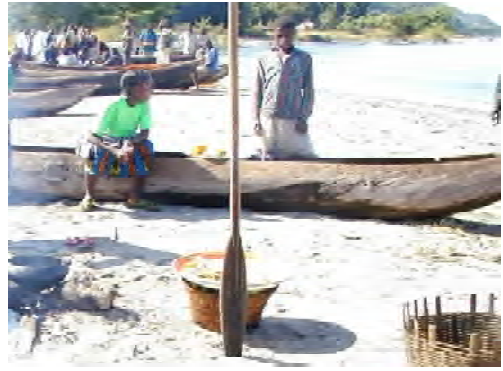
■くり抜きカヌー。ニャサ湖では漁船のほぼ100%が同型のカヌーである。非効率的な木材の利用方法は森林資源への影響もあり、木板を使った漁船への転換がもとめられる。
