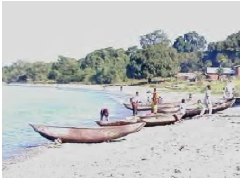
■くり抜きカヌー。ニャサ湖では漁船のほぼ100%が同型のカヌーである。非効率的な木材の利用方法は森林資源への影響もあり、木板を使った漁船への転換がもとめられる。
