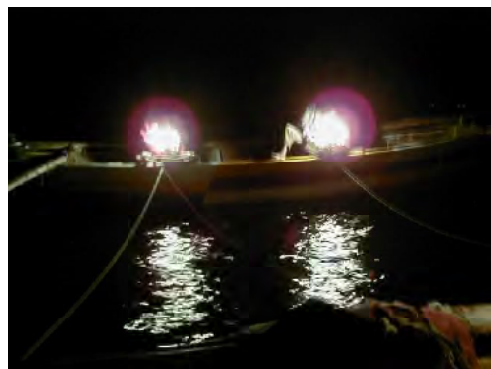
■ダガーリフトネットの構造と夜間の操業風景。リフトネットは夜間集魚灯を使って浮上してきたダガーを巻き取る漁法で、非常に効率的なダガー漁法と考えられる。ただし集魚灯には水中への光の進入を最大にするよう、反射板を改善するなど、改良の可能性が認められる。
