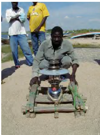
■ダガー漁獲用の灯油ランプ。光量が集魚効率に大きく影響する。
