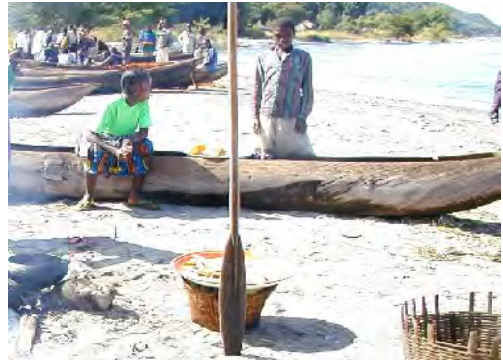
■ダグアウトカヌー。船外機、帆は用いられず、動力はパドルによる手漕ぎ。材料となる木によって耐久性が異なる。
