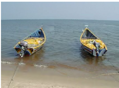
■ナイルパーチ刺網漁船。25-40HP の船外機を装填する。
