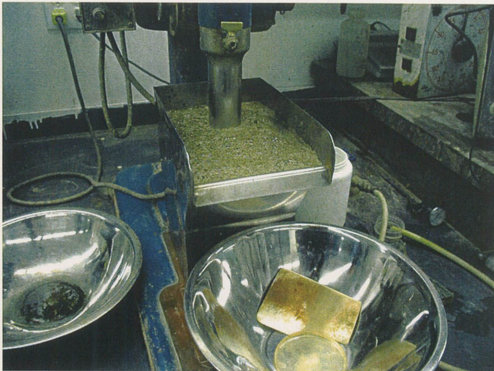
BaSO 4 -flotation test
