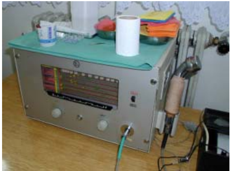
導子をテープで修理し、使用している超音波治療器 (旧ユーゴスラヴィア製、 1980年代製造)
