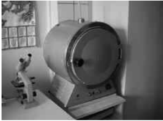
乾熱滅菌器（生化学検査室、診断棟）
