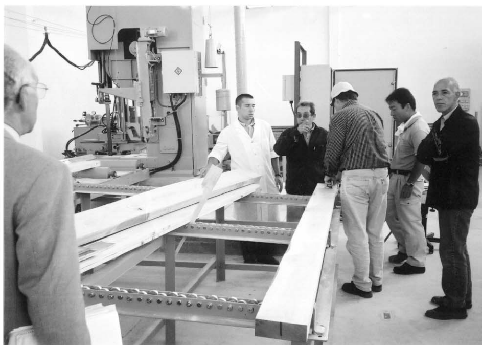
製材機による試験片の作製（製材実験棟内）
