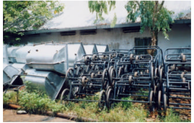
出荷を待っているゴミ収集ハンドカートの車体と容器。機械整備工場では、ゴミ運搬車両の修理・点検の他に、ゴミ収集ハンドカートをも作っている。
