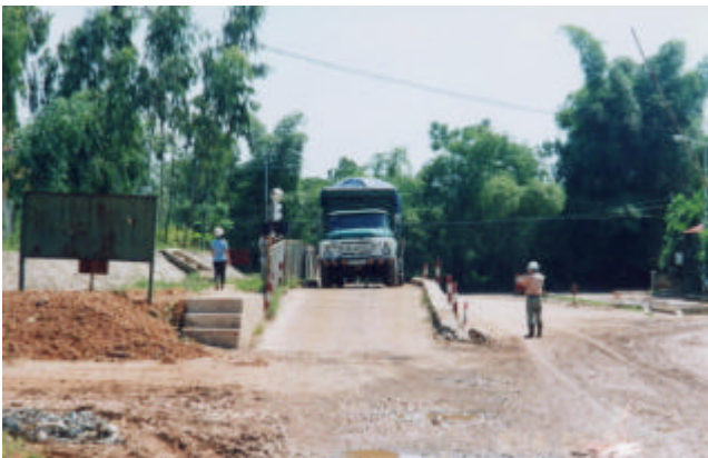
処分場の入口に設置されたトラック・スケールで重量を測っているゴミ運搬車両。
