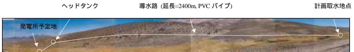
タンボ・ケマード小水力発電計画地点の全景 (オルロ県サハマ州トゥルコ郡チャチャコマニ・カントン)
