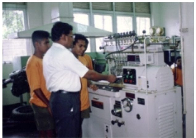
ディーゼル噴射器の検査装置の使い方を教わる訓練生たち
