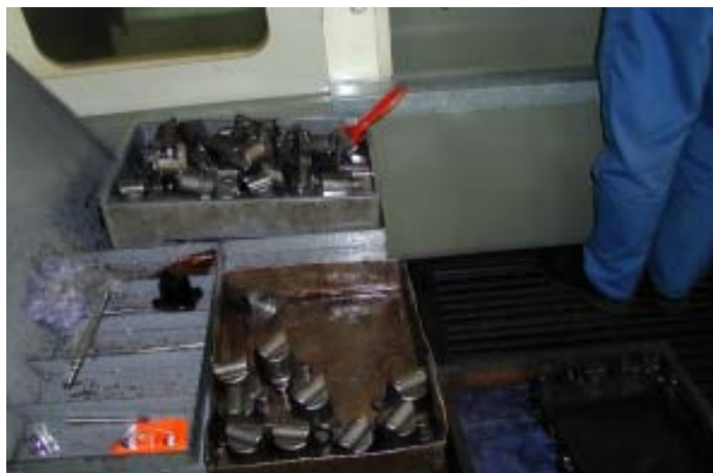
写真3-3-1 部品トレイの内部にワークと切削油や切粉が混在している（改善前）
