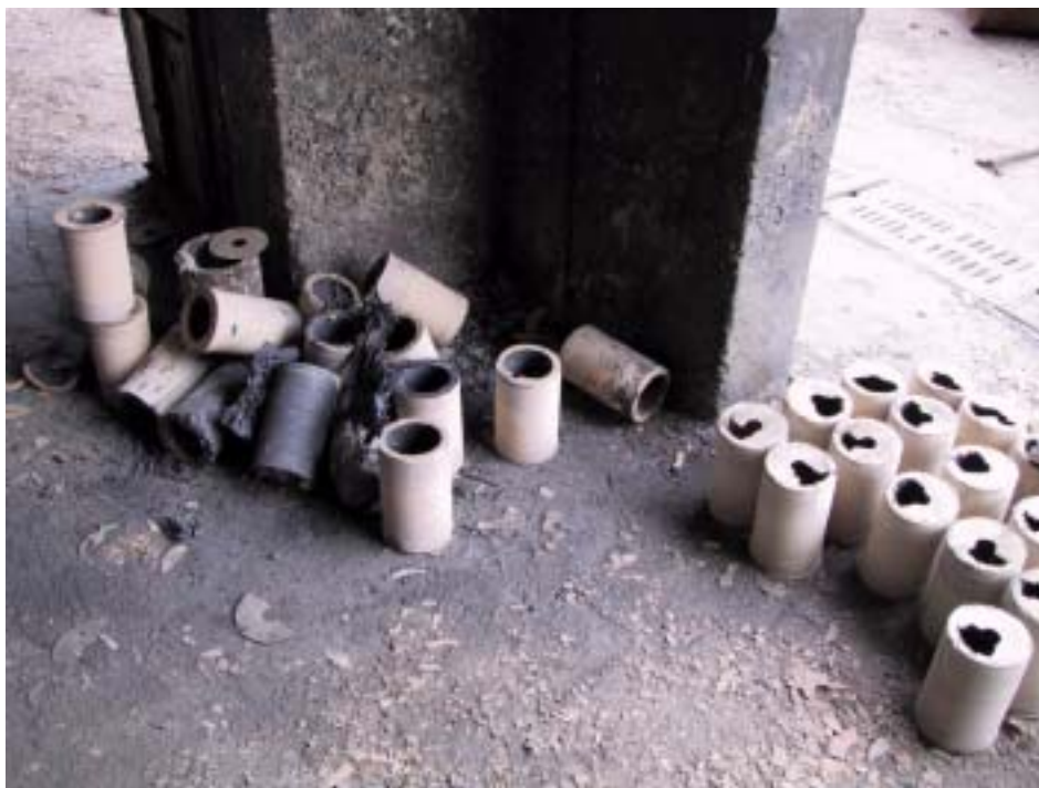
写真 2 - 4 - 1 改善前の現品管理の様子 ( 建屋柱近辺のワークは不良品、右側の並んでいるのが合格品 )
