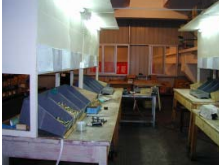
写真3 - 1 - 2 U字ラインの1個流し組立工程（改善後）
