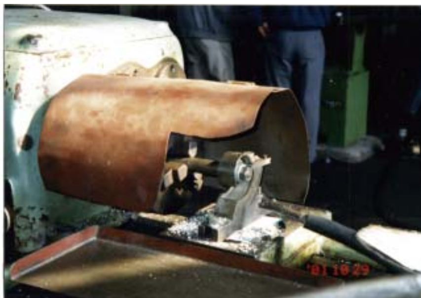
写真 1 - 1 1 - 1 切粉飛散防止カバーの取付（改善後）
