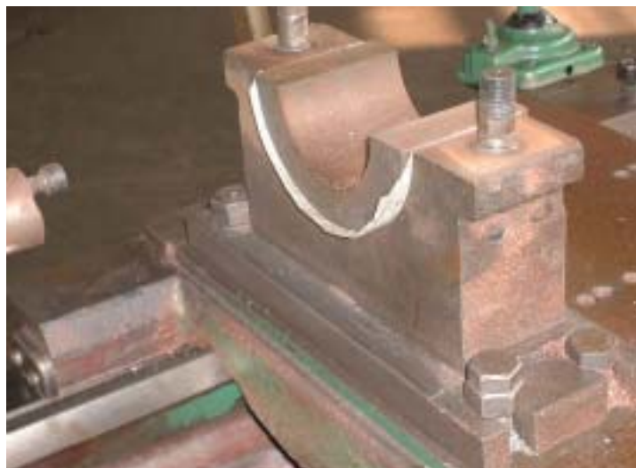
写真 1 - 3 - 1 取付具の芯だし作業
