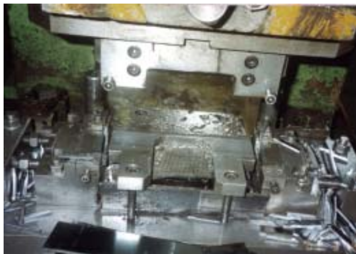
写真1 - 5 - 1 両端面切断のプレス金型部
