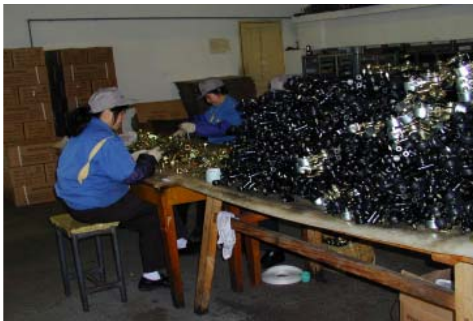
写真 3 - 1 - 1 ロット単位にまとめて組立をしている（改善前）
