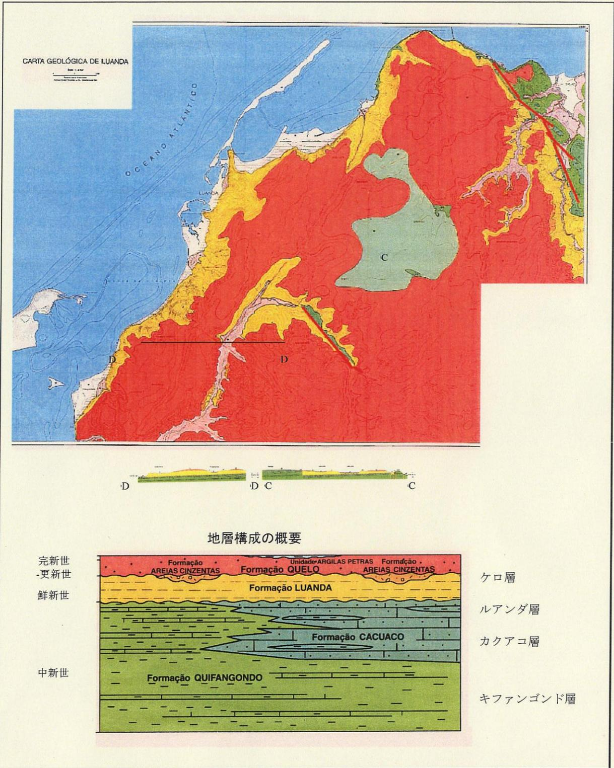
図-2.4.4 ルアンダの地質平面図および断面図
