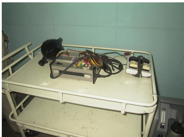
手術室における心電計。 電極ケーブル類の劣化が著しい。
