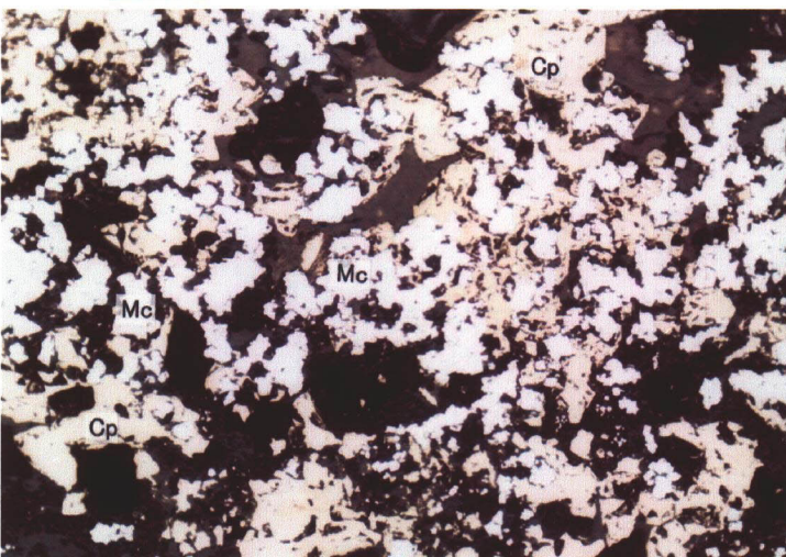
鉱徴地番号：E13, 孔名：01SFLC17, 試料番号：PL01 試料名：塊状硫化鉱 (CM) 記載：塊状黄銅鉱鉱石。粒度は多様。
