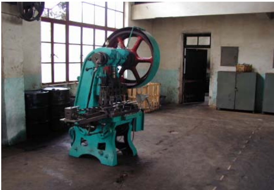
図 2 - 7 - 1 3 コレット成型用トランスファプレス
