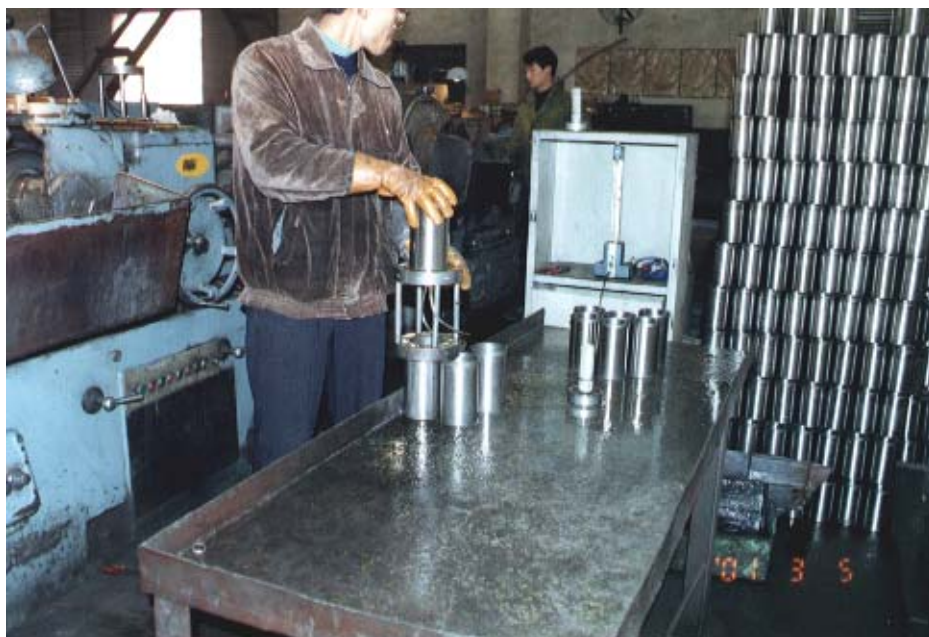
写真 2 - 5 - 3 外径検査（エアーマイクロ）の状況 自動定寸装置を全研削盤及びホーニング盤にも取り付ける必要がある。
