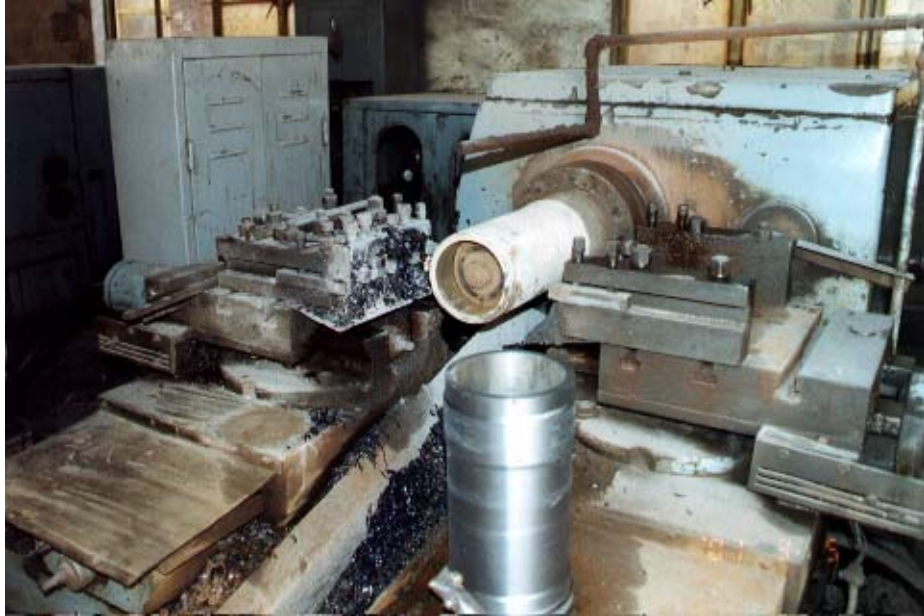
写真 2 - 3 - 1 外径粗加工機械 油圧半自動旋盤、4～8本のバイトを使用する多刃旋盤で、 バイトは作業者が刃研磨する。
