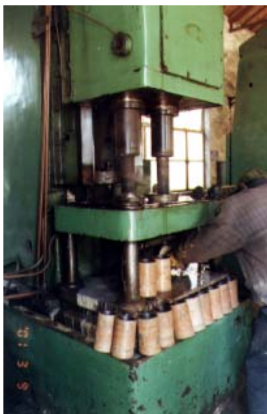
写真 2 - 3 - 4 内径粗加工（2軸縦型中ぐり盤） 4枚刃超硬工具を使用し、超硬チップの蠟付け交換・工具研磨は、社内で行っている。
