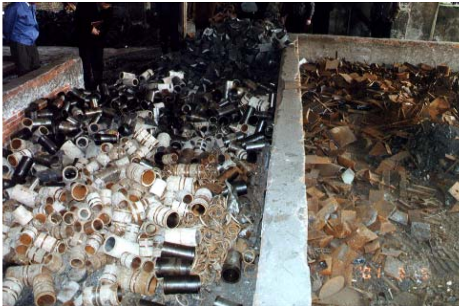
写真 2 - 1 - 4 鑄鉄リターン材屋内保管状況
