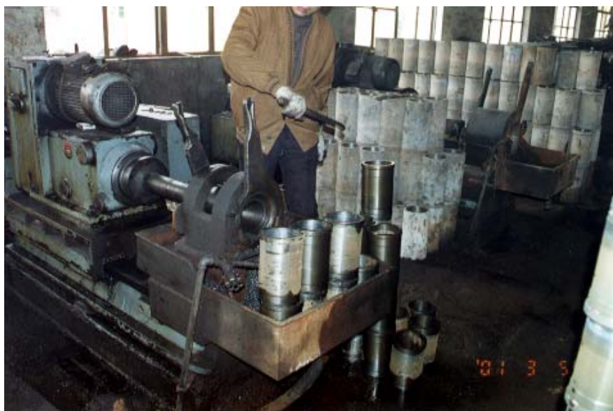
写真 2 - 3 - 3 内径粗加工（横型中ぐり盤） 加工代により、内径荒削りを外径荒削り後再加工するものもある。
