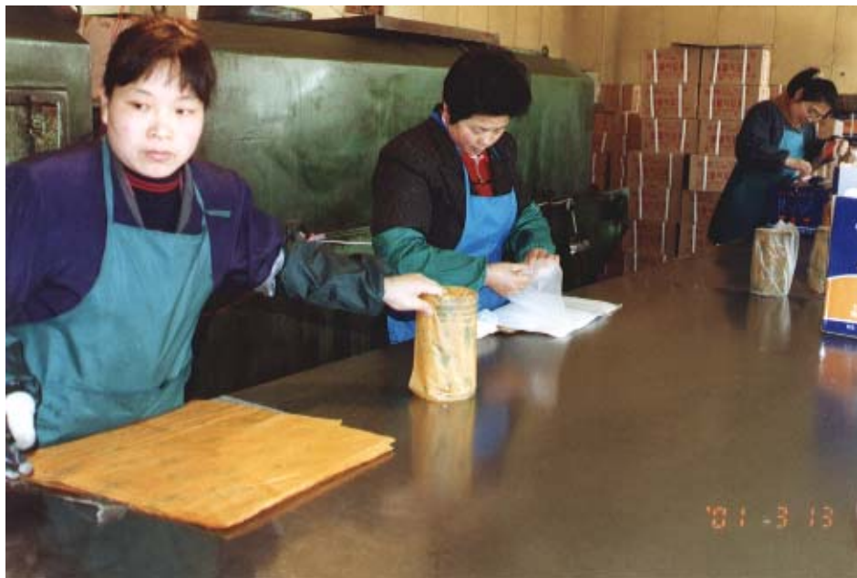
写真 2 - 7 - 2 防錆・梱包作業
