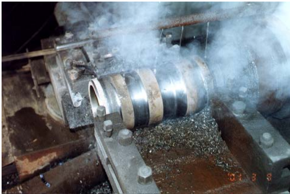
写真 2 - 3 - 2 外径粗加工の様子
