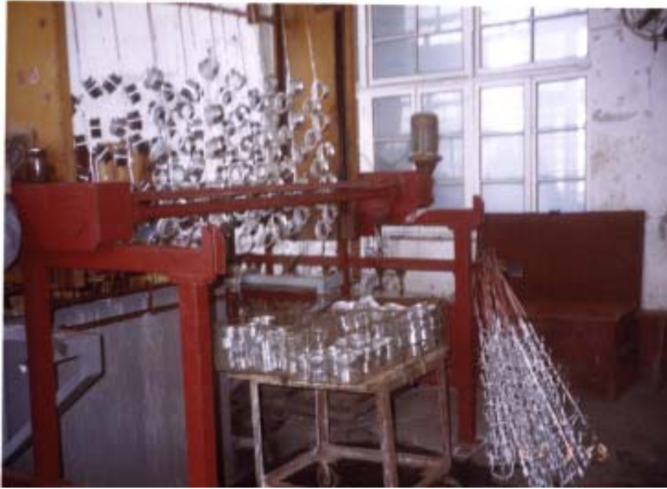
図 2 - 3 - 9 メッキ工場の連続処理装置 ( 1 )
