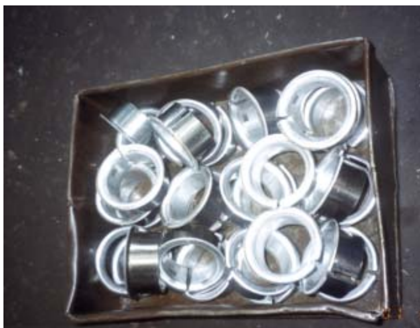
図 2 - 3 - 7 つば出し成形後の部品
