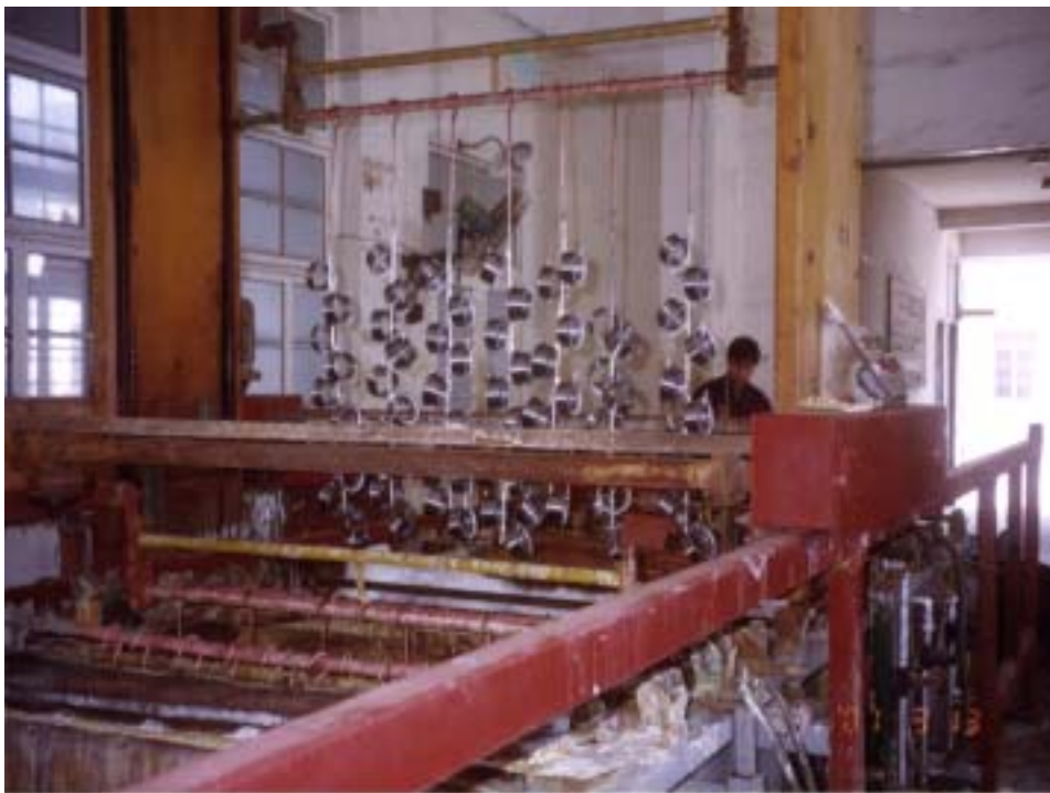
図 2 - 3 - 10 メッキ装置の連続処理装置 ( 2 )
