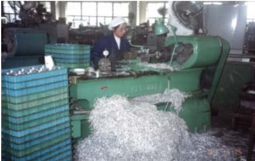
図 2 - 2 - 1 1 切粉の飛散状況
