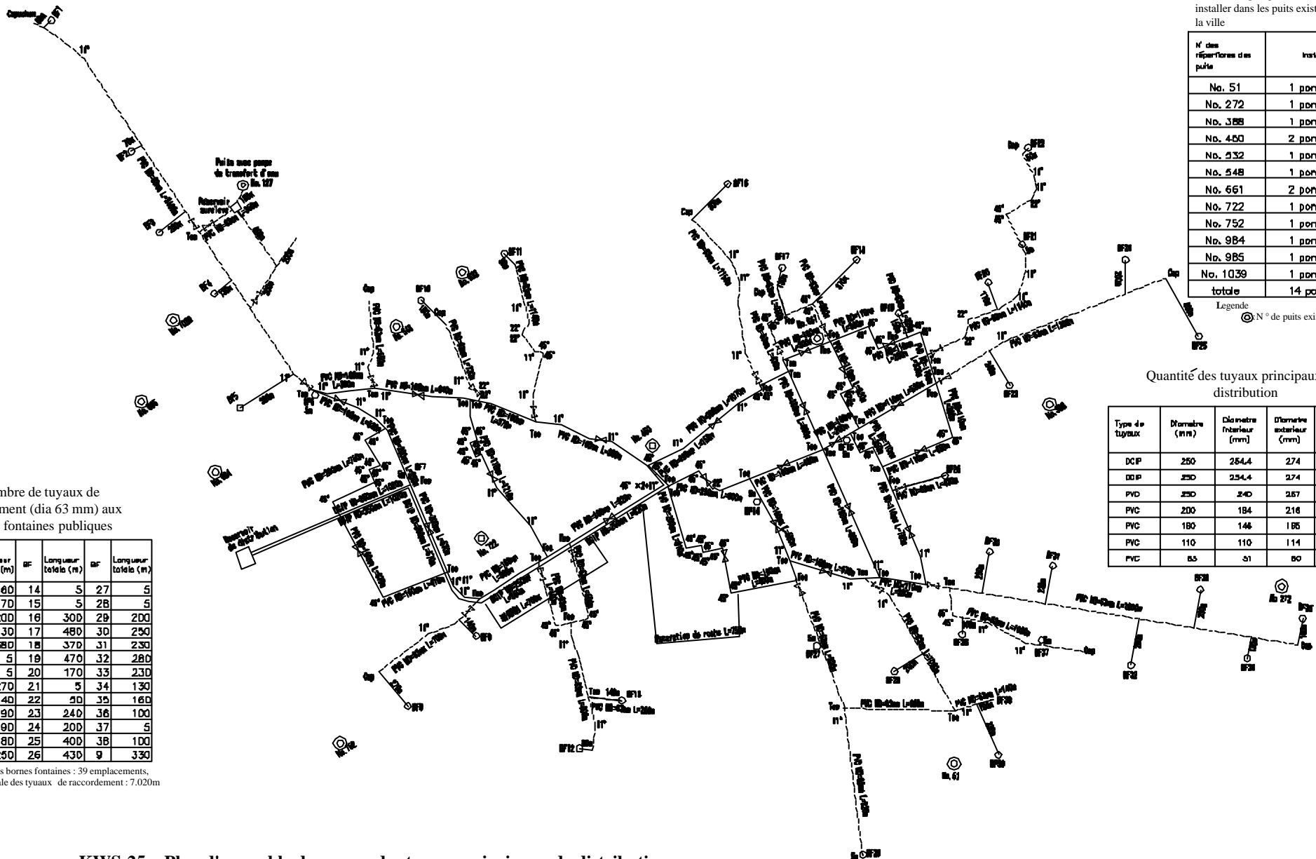
KWS-25 Plan d'ensemble du réseau des tuyaux principaux de distribution (tuyaux principaux de distribution, tuyaux de raccordement aux bornes fontaines publiques, puits existants de la ville)
